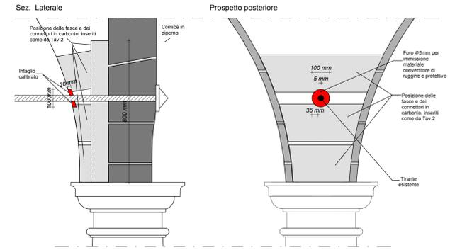
A) INTAGLIO CALIBRATO CIRCOLARE: diametro 100 mm, per trattamento del tirante esistente.
